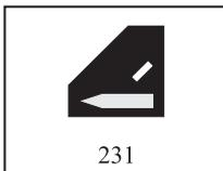
Sulla parte posteriore del segnale è dipinta una freccia bianca, che indica il binario d'appartenenza.
