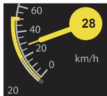
è stata data un'autorizzazione al movimento CAB. È stata raggiunta la curva di frenatura. La velocità di liberazione ammonta a 20 km/h.
