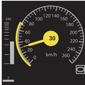
è stata data un'autorizzazione al movimento CAB. È stata raggiunta la curva di frenatura. La velocità finale ammonta a 0 km/h. La fine dell'autorizzazione al movimento CAB sarà raggiunta in 240 metri.
