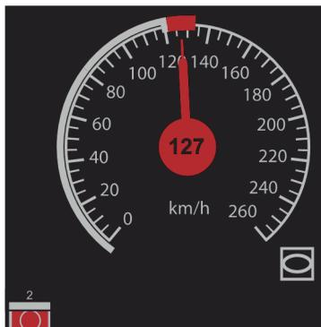
la velocità massima ammessa è stata superata. La velocità viene ridotta automaticamente con una frenatura di sistema o vi è una frenatura imposta.
